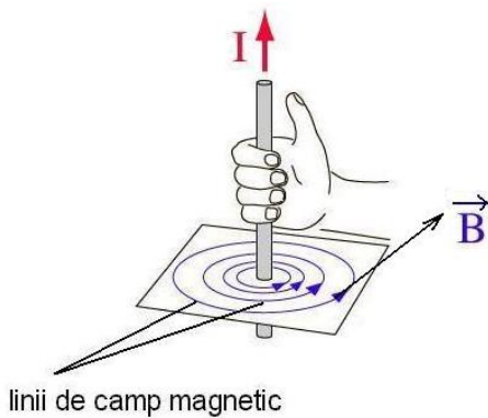
Fig. 13 Regula burghiului (a mâinii drepte) folosită pentru stabilirea sensului liniilor de câmp magnetic ce se stabilește în jurul unui conductor străbătut de curent electric continuu; inducția magnetică \vec{B} are același sens cu liniile de câmp și este tangentă la acestea
