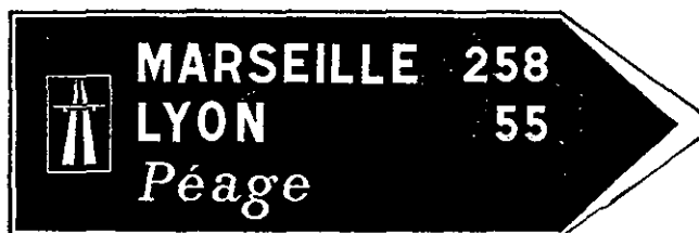
Signal D 13 bis Jalonement vers une entrée d'autoroute.
