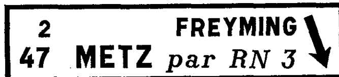
Signal D 230 ab 2 bis Signalisation de direction vers la sortie sur potence ou portique avec indication de distance (cas exceptionnel).
