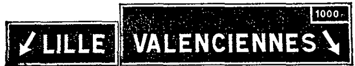
Signal D 213 a 2 Présignalisation d'une bifurcation à larges caractéristiques géométriques.
