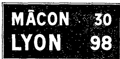
Signal D 240 ab 1 Confirmation de direction. Exemple 1.
