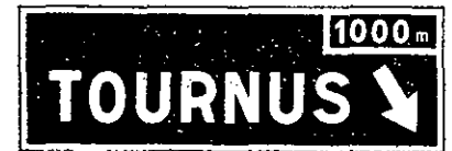
Signal D 211 b 2 Présignalisation de sortie courante.
