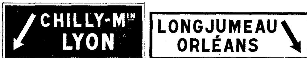
Signal D 222 a 2 Signalisation avancée de sortie principale à larges caractéristiques géométriques.
